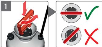
**Pumpe korrekt entriegeln**
