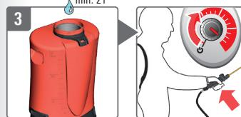
Sauberes Wasser nachfüllen, Gerät einschalten (max. Druck), sprühen bis kein Flüssigkeit mehr austritt
