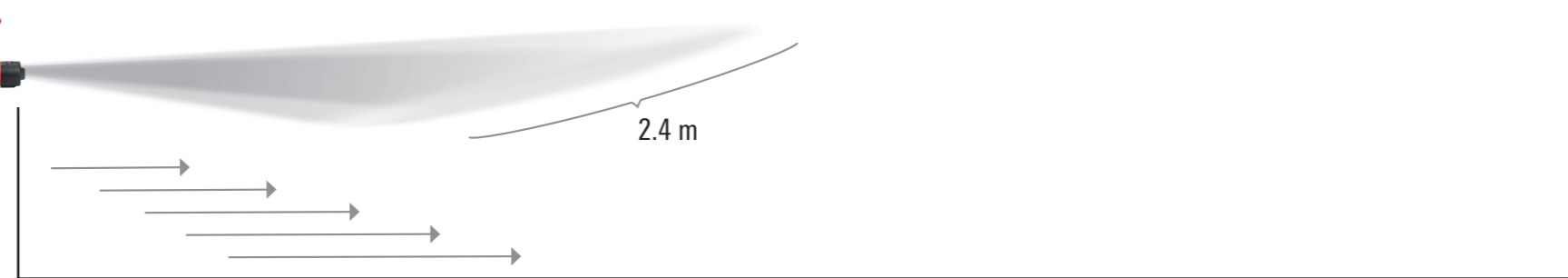
Sprühdistanz ohne Luft bis 2 m 2.5 bis 5 m, je nach Sprühgebläsestufe
