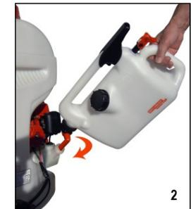
Tenir le bidon de façon droite durant le remplissage (image 1). Pour dévier la tubulure complètement, tourner le bidon légèrement (image 2), pour que le reste de l'essence puisse découler.
