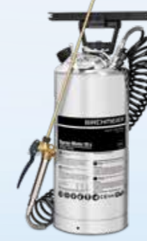
Spray-Matic 10 S 10 Liter Druckspeicher-Sprühergerät, Messing Handpumpe, 6 bar, Messing Regulierdüse, Sicherheitsventil, Pressluftanschluss, separate Einfüllöffnung, Viton Dichtungen Art.Nr. 11380002 mit Handpumpe Art.Nr. 11380004 ohne Handpumpe
