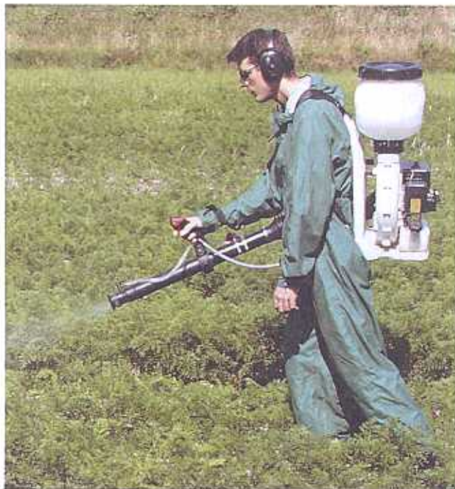
Abb. 7: Luftleistung bei dicht wachsenden Kulturen wie Karotten (Bild) oder Kartoffeln so regulieren, dass die Sprühbrühe in die Kultur eindringt und auf dem Blattwerk anlagert, jedoch nicht durch die Kultur hindurchgeblasen wird ohne anzulagern. Ein kurzer Test vor der Behandlung mit Wasser und wassersensitivem Papier ist empfehlenswert. Demonstrations-Sprühgeräteeinsatz mit Wasser als Sprühmittel. Im praktischen Einsatz unbedingt Anwenderschutz beachten (siehe Seite 2).
