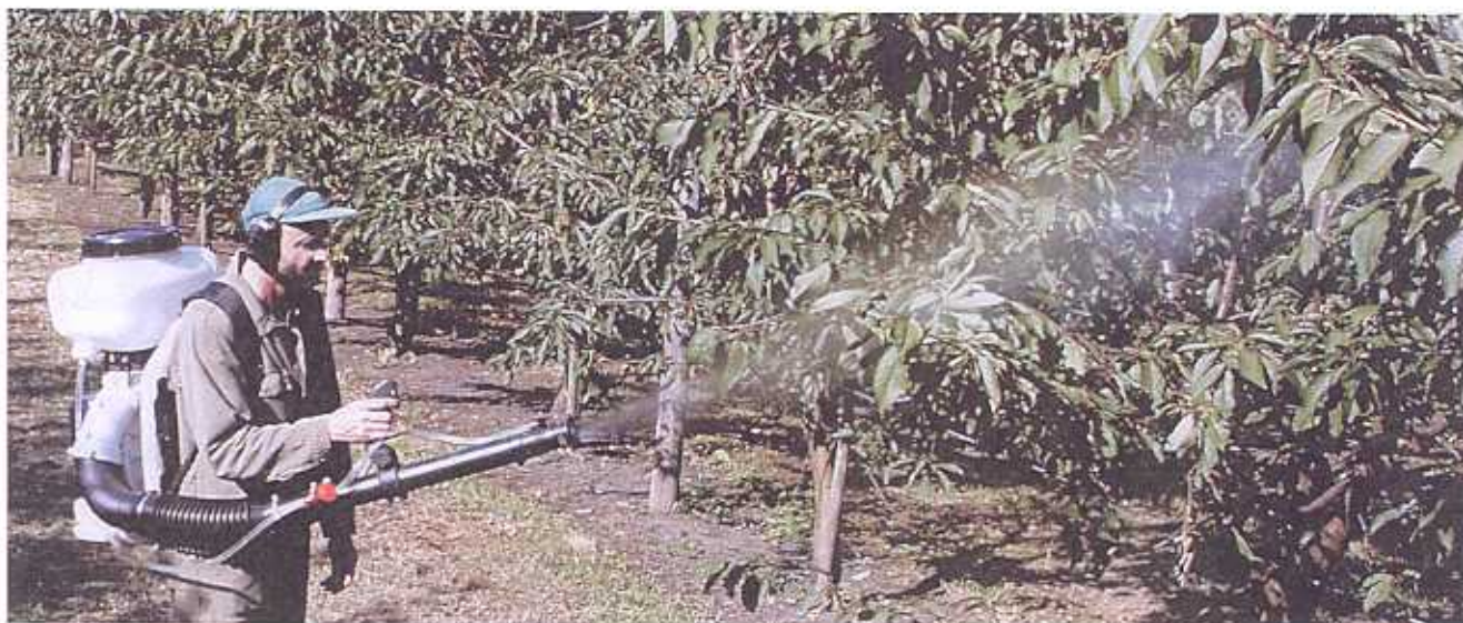
Abb. 8: Bei voller Motorleistung können mit dem Microniseur B245 Bäume bis zu einer Höhe von 5,0 Meter wirksam besprüht werden. Der Tankdeckel muss gut dichten (Moosgummidichtung) und ganz zuge dreht sein, damit der nötige Überdruck erzeugt werden kann. Das Blasrohr sollte nicht zu steil gehalten werden, damit die volle Sprühleistung erzielt werden kann; im Bild Halbstammkirschen. Demonstrations-Sprühgeräteeinsatz mit Wasser als Sprühmittel. Im praktischen Einsatz unbedingt Anwenderschutz beachten (siehe Seite 2).
